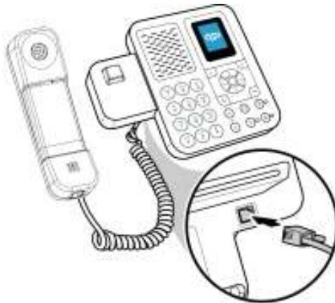
3. 付属の LAN ケーブルを電話の LAN(RJ45)ポートに接続します。もう一方の端をブロードバンドルータに接続します。
