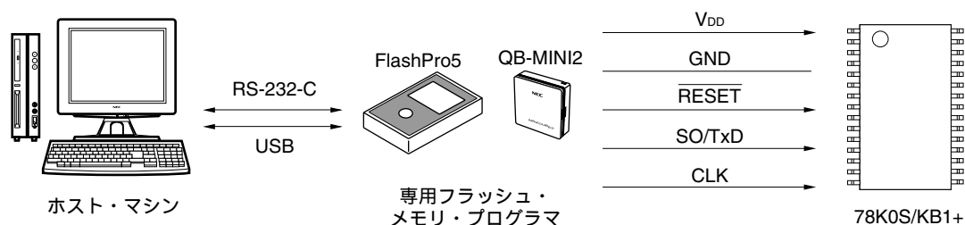
図19-2 フラッシュ・メモリにプログラムを書き込むための環境 (FlashPro5/QB-MINI2)
